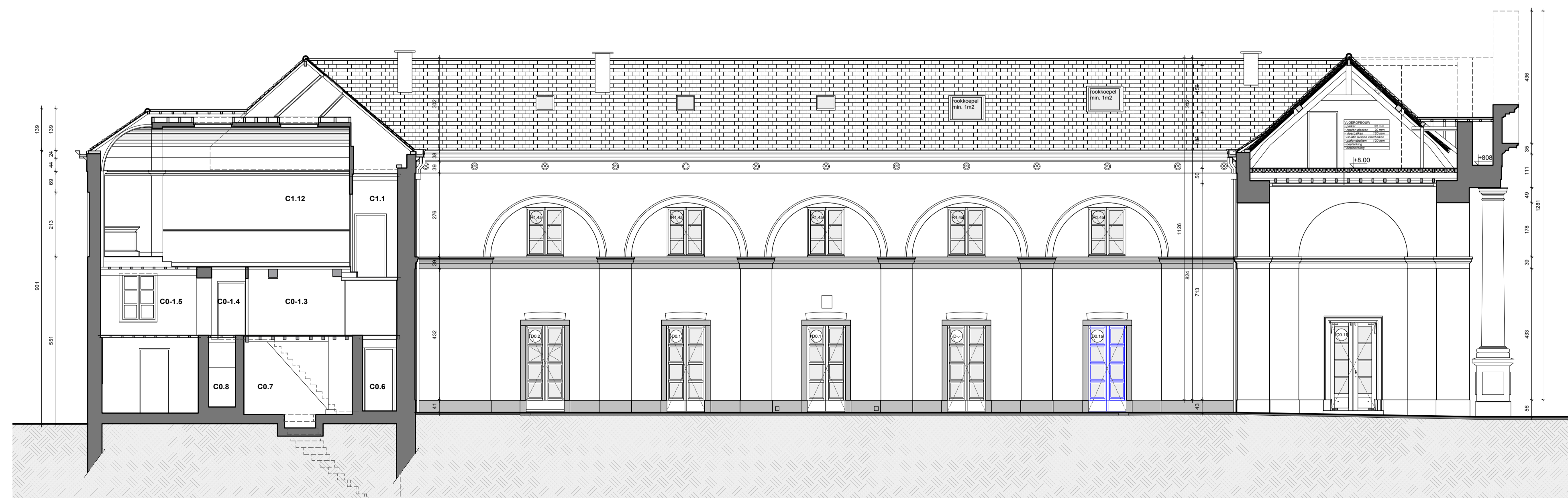
DOORSNEDE BB / GEVEL BINNENKOER DEEL B
